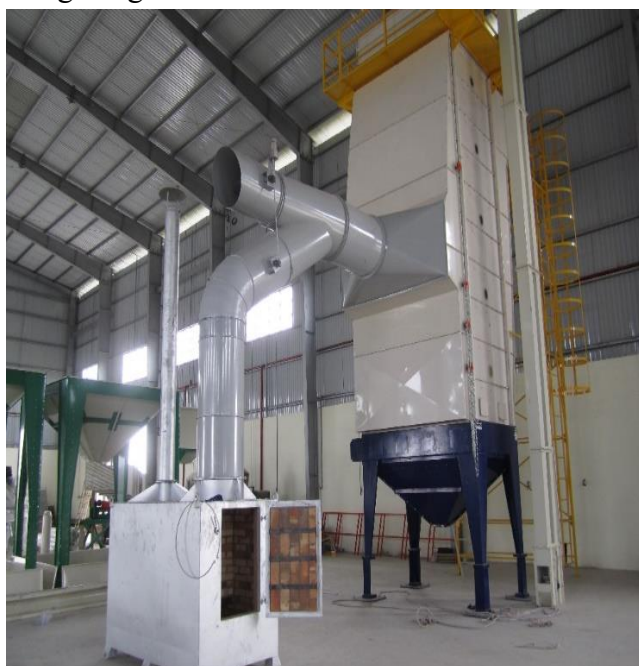
Hình 2. Máy sấy tháp MT6 được chế tạo và lắp đặt hoàn thiện.
