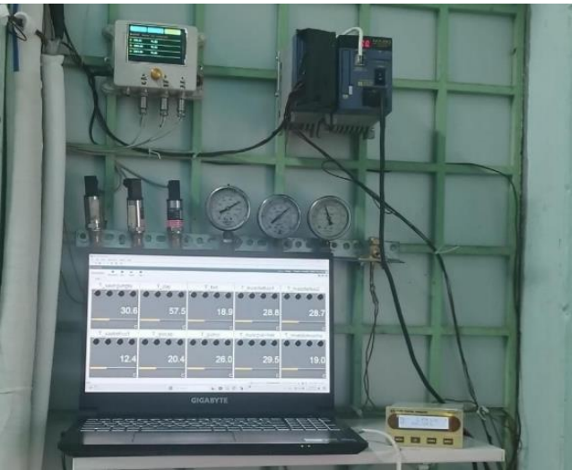
Hình 03. Bộ lấy tín hiệu nhiệt độ MX100, áp suất và cảm biến lưu lượng. Các thông số nhiệt độ, áp suất, lưu lượng môi chất lạnh R744 được thu thập khi chạy thử nghiệm được thể hiện qua Hình 03 với độ chính xác cao.
