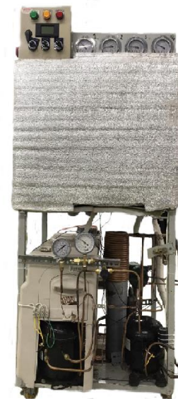
Hình 5: Hệ thống lạnh ghép tầng R134a/ CO 2
