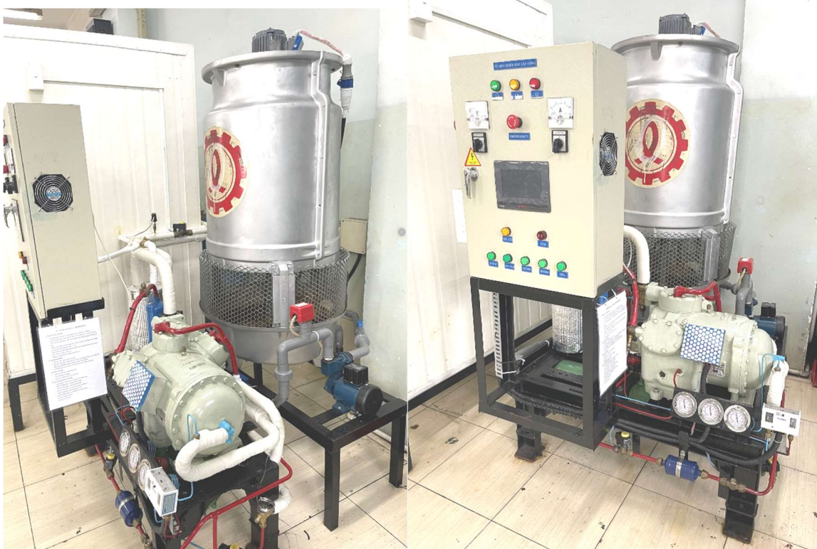
Hình 6: Mô hình hệ thống Kho cấp đông 2 cấp sử dụng thiết bị làm mát trung gian ống lồng ống điều khiển và giám sát thông qua PLC bố trí trong phòng F4.1.
