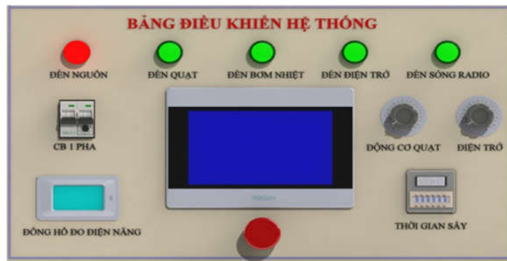
Hình 3. Bảng điện điều khiển mô hình máy sấy
