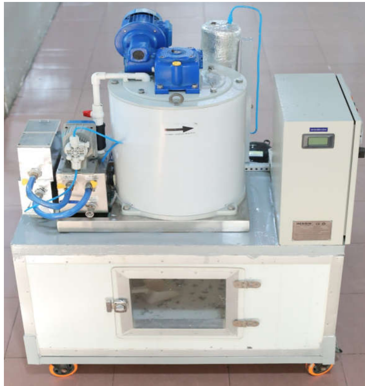
Hình 3. Mô hình hệ thống Cối đá vẩy dàn trải
