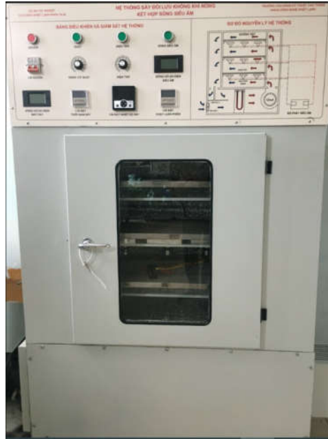
Hình 2. Hình ảnh thực tế mô hình máy sấy đối lưu không khí nóng kết hợp sóng siêu âm
