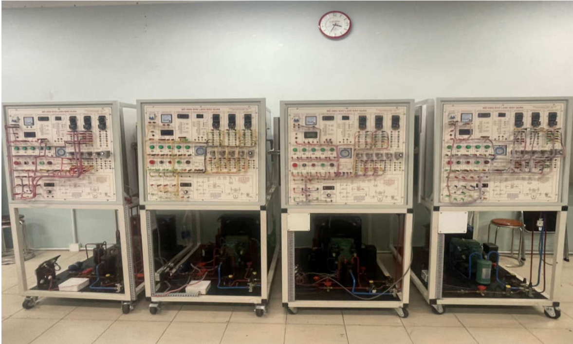
Hình 1. Hình ảnh thực tế mô hình kho lạnh công nghiệp
