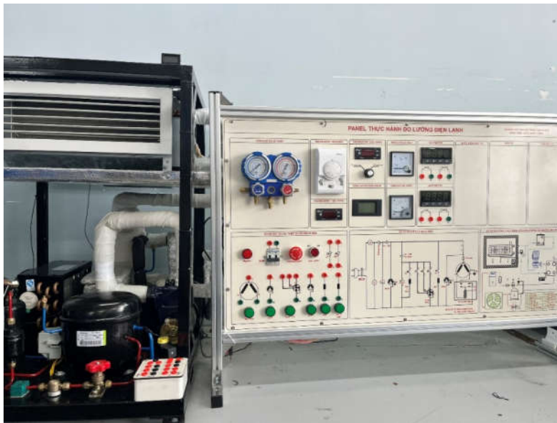
Hình 1: Mô hình panel điều khiển hệ thống điều hòa không khí Water Chiller
