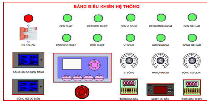
Hình 3. Bảng điện điều khiển mô hình máy sấy bơm nhiệt kết hợp kết hợp vi sóng, hồng ngoại và sóng siêu âm
