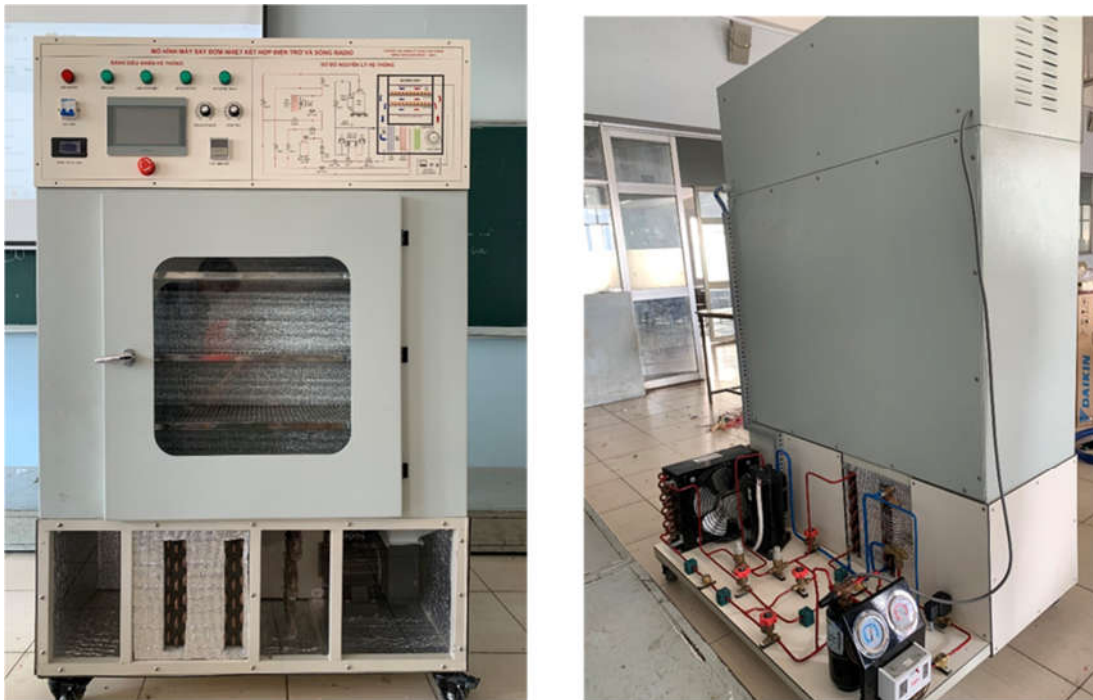
Hình 4. Hình ảnh thực tế mô hình máy sấy bơm nhiệt kết hợp điện trở
