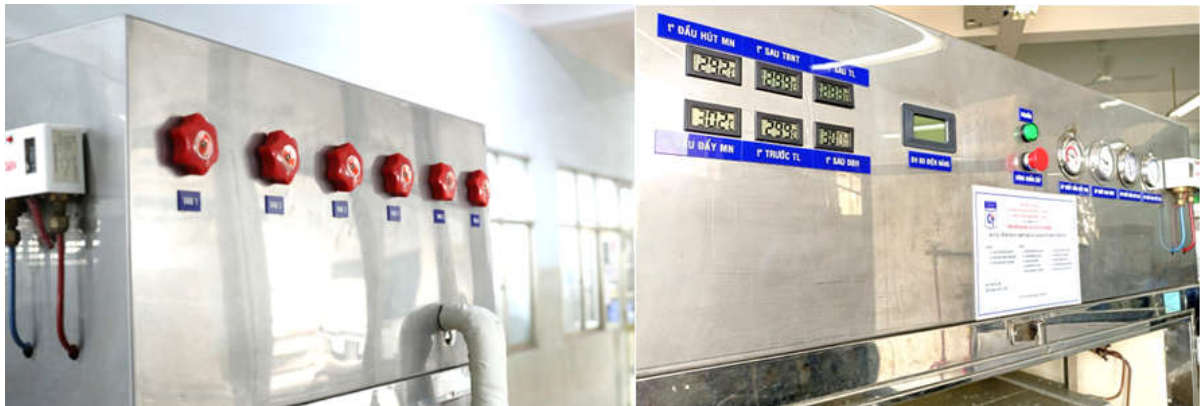
Hình 4. Cụm van điều chỉnh chế độ và hiển thị thông số làm việc.
