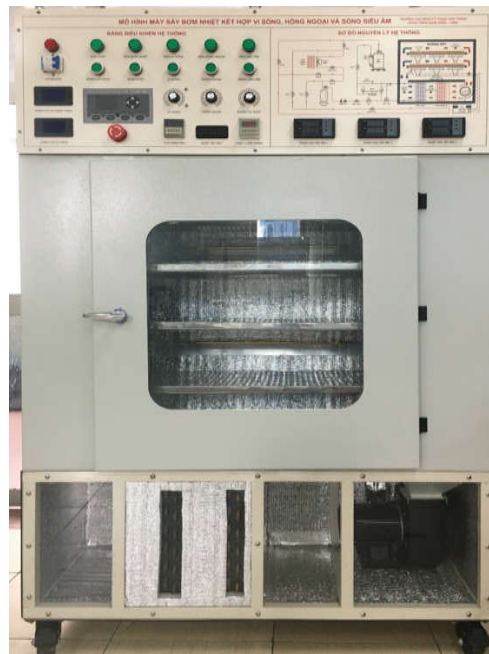
Hình 4. Hình ảnh thực tế mô hình máy sấy bơm nhiệt kết hợp kết hợp vi sóng, hồng ngoại và sóng siêu âm.
