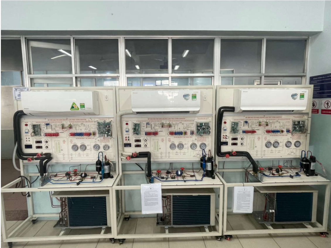
Hình 1. Hình ảnh thực tế mô hình dàn trải Điều hòa không khí hai khối treo tường
