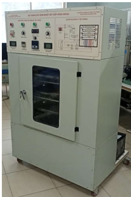
Hình 1. Hình ảnh thực tế mô hình máy sấy bơm nhiệt kết hợp hồng ngoại
