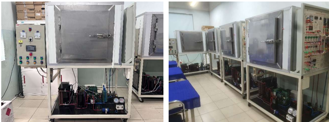
Hình 1. Mô hình hệ thống kho lạnh bảo quản thực phẩm bố trí trong phòng F4.10A
