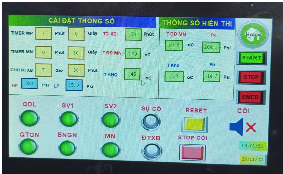
Hình 4. Giao diện vị trí các phím chức năng điều khiển Auto
