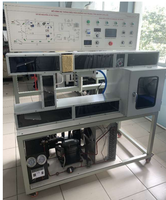
Hình 1. Hình ảnh thực tế mô hình hệ thống điều hòa không khí trung tâm water chiller sơ đồ tuần hoàn
