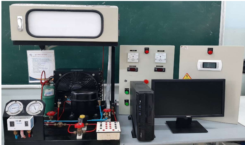
Hình 1. Mô hình điều khiển PLC giám sát kho lạnh
