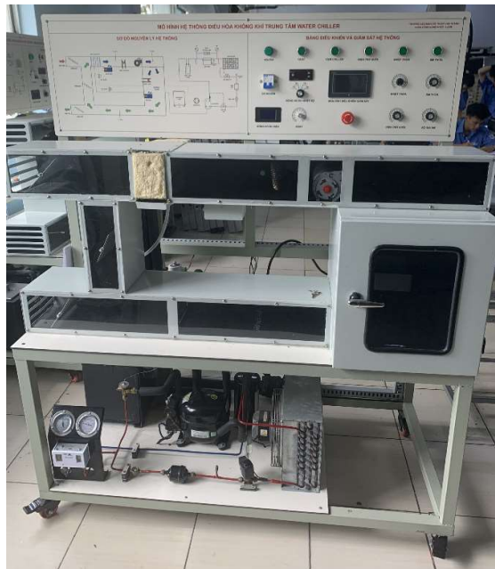
Hình 1. Hình ảnh thực tế mô hình hệ thống điều hòa không khí trung tâm water chiller sơ đồ thẳng
