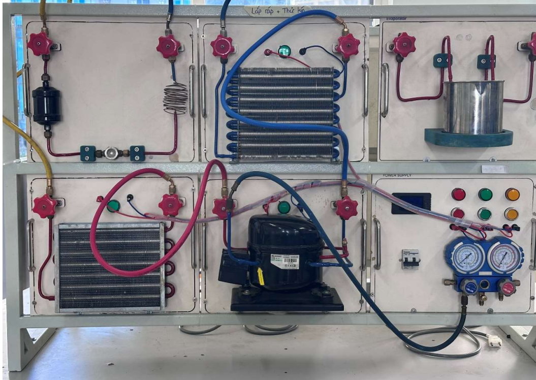
Hình 1. Mô hình hệ thống lạnh cơ bản giải nhiệt không khí
