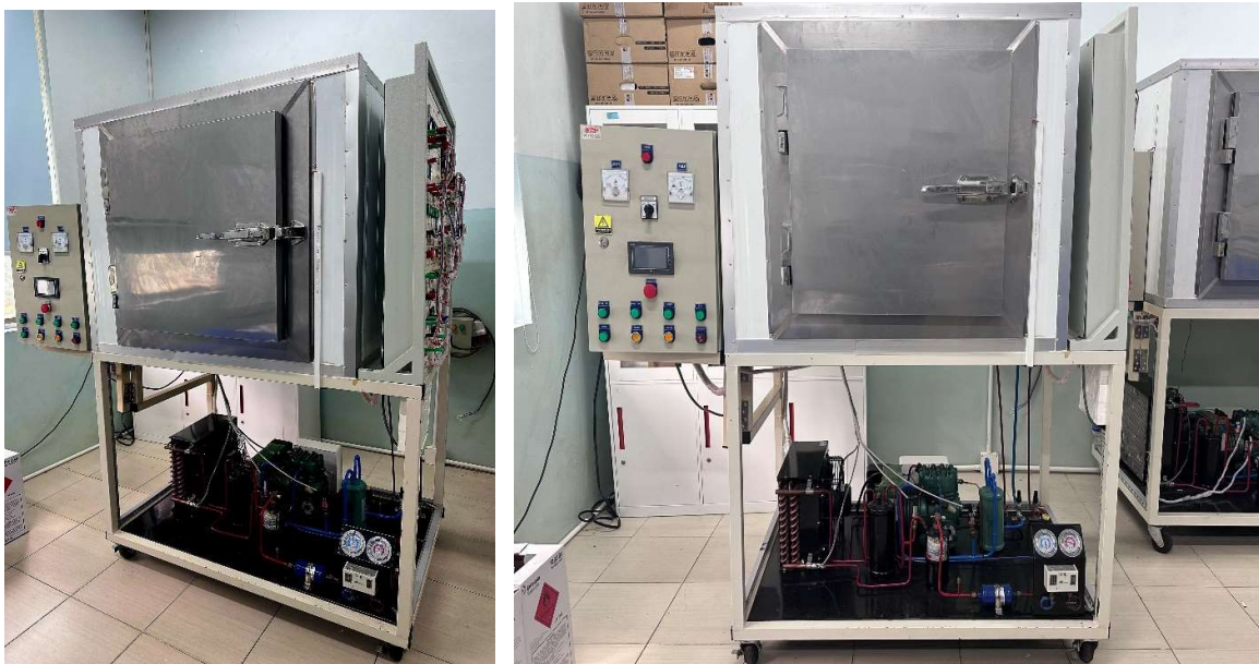
Hình 1. Mô hình điều khiển hệ thống tủ đông gió bảo quản thực phẩm bằng phần mềm PLC
