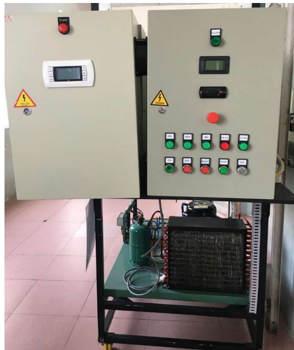
Hình 1. Mô hình TT đa năng điều khiển PLC giám sát kho lạnh
