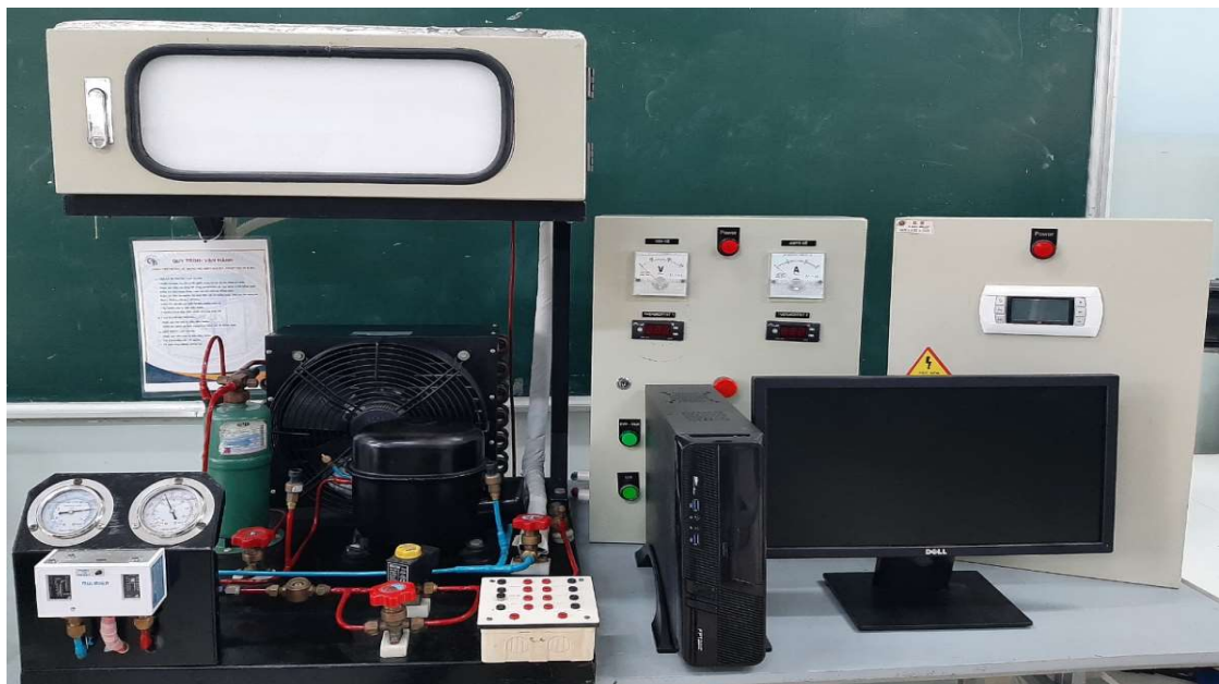
Hình 1. Mô hình điều khiển PLC giám sát kho lạnh
