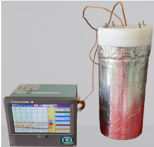
Hình 2.3. Sơ đồ thí nghiệm xác định hệ số dẫn nhiệt của VLS
