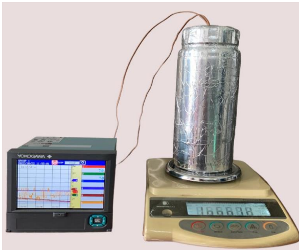
Hình 2.2. Sơ đồ thực nghiệm xác định nhiệt dung riêng của VLS
